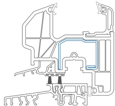
Flache Aluminium Bodenschwelle: Höhe 20 mm
